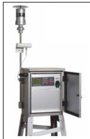
Слика бр. 10/11: Сет за мерење и узоркување на цврсти честички Micro Dust Pro Realtime Aerosol Monitor, Apex lite pump - Cassela Cel и TECORA ECHO PM
