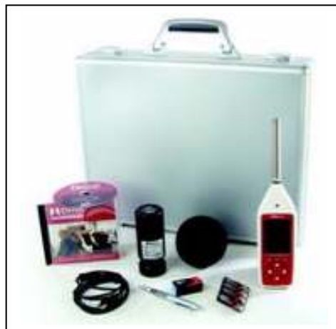
Слика бр. 9: Инструмент за мерење на бучава Cirrus тип CR:161C
